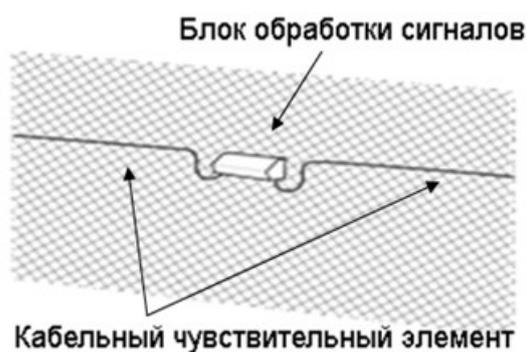
В системах Годограф и Дельфин подведение питания и снятия информации осуществляется отдельными линиями для каждого БОС. ЧЭ соседних участков не соединены друг с другом. Для каждого участка (на рис.2 – 400 м.) устанавливается шкаф (рис . 4), в котором размещается БОС, блок питания, блок грозозащиты и интерфейсный модуль.
