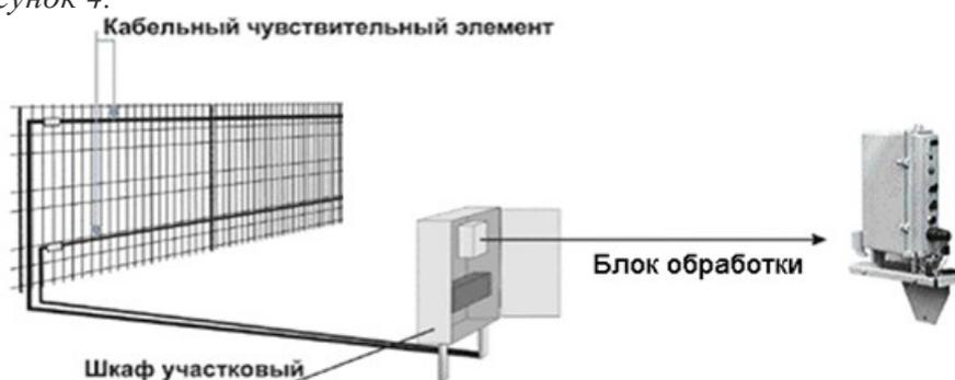
Таким образом, первое структурное отличие систем дельфин и Годограф от системы Intrepid заключается в необходимости устанавливать шкафы с дополнительным оборудованием и прокладывать дополнительные линии связи (информационные и питания).
