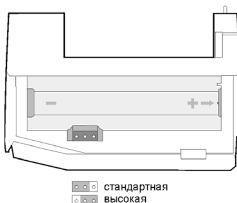
Рис. 6. МЕСТОПОЛОЖЕНИЕ ПЕРЕКЛЮЧАТЕЛЯ ЧУВСТВИТЕЛЬНОСТИ
